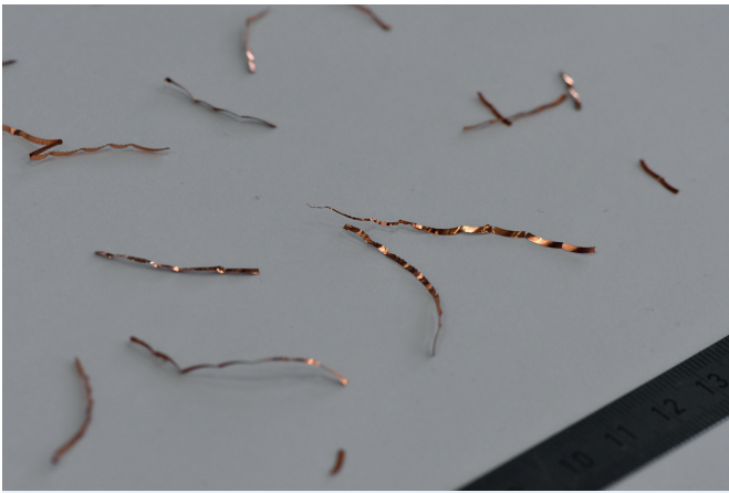
Bild 2 a und b: MMS-System plus Hochdruck plus Einlippenbohrer plus Prozessdesign: Die Späne unterscheiden sich zu bisher praktizierten Verfahren gravierend. Bei der Bearbeitung von hochreinem Kupfer konnte der Vorschub pro Umdrehung gegenüber Öl um bis zu 70 % erhöht werden
