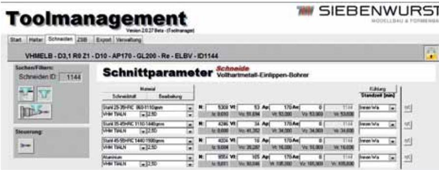
**Bilder 3, 4 und 5:** Ein Muss stellt das Verwalten der Zerspanungswerkzeuge in der hauseigenen Siebenwurst Tool DB dar. Hier werden alle Schnittparameter, Geometriedatenverwaltung, Lagerorte etc. der einzelnen Schneidentypen aus dem Fräs-/Bohr-/Gewinden-/Drehbereich in den einzelnen Materialgruppen dokumentiert und den CAM Anwendungen per Datensatz zur Verfügung gestellt.
