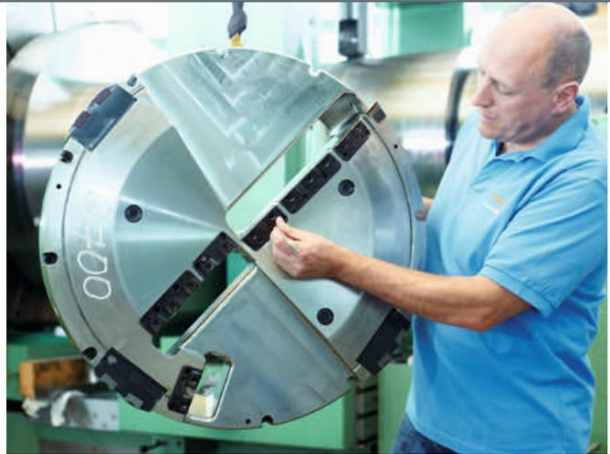
5 Tieflochbohrwerkzeug von Botek Typ 43 für das Vollbohren mit 700 mm Durchmesser
