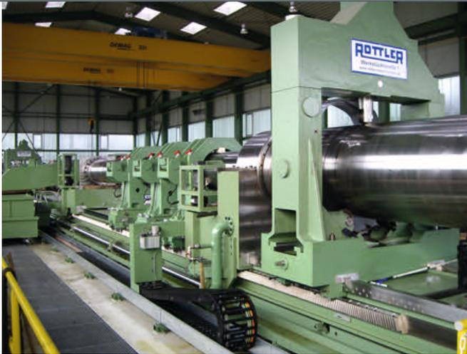
4 Tieflochbohrmaschine der Baureihe TFB im Einsatz bei der Firma Hilfrich in Dormagen
