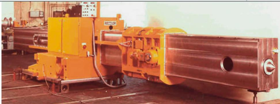
**3** Transportables Ausdrehsystem zur Adaption auf Flachbettdrehmaschinen ermöglichen das Ausdrehen frei programmierbarer Innenkonturen von Walzen, Zylindern und Großrohren
