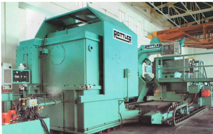
1 Ausdrehmaschine der Baureihe ABD für die kombinierte Außen- und Innenbearbeitung zylindrischer Bohrungen
