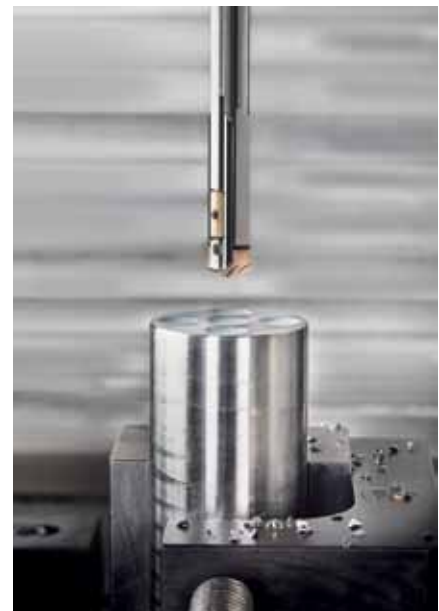
Bild 5: Anwendung Bohrtiefe >7 x D (Werkbilder: botek Präzisionsbohrtechnik GmbH, Riederich)
